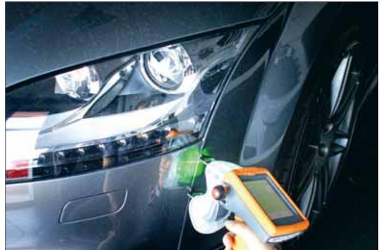
Die Spalten zwischen den Bauteilen der Autokarosserie werden vermessen und mit den Sollwerten verglichen. Geschieht diese Qualitätskontrolle laufend während der Produktion, verkürzen sich die Produktionszeiten enorm.
