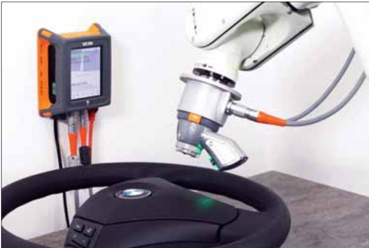
Eine wichtige Anwendung für die GapGun ist die Automobilindustrie. Der Laser scannt das eben produzierte Lenkrad und überprüft alle Nahtstellen. Sollte ein Wert außerhalb der Toleranzgrenzen liegen, wird automatisch Meldung gemacht.
